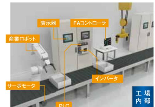
PLC (Programmable Logic Controller) とは、工場などの自動機械を制御する信頼性の高い小型コンピュータのこと。
