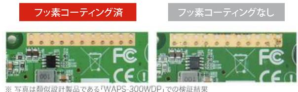
\*1 JIS C 60068-2-43に規定された試験条件下で21日間試験を実施し、DUTが正常に動作することを確認。 <試験条件> 硫化水素:10～15ppm、温度:25±2℃、湿度:75%
